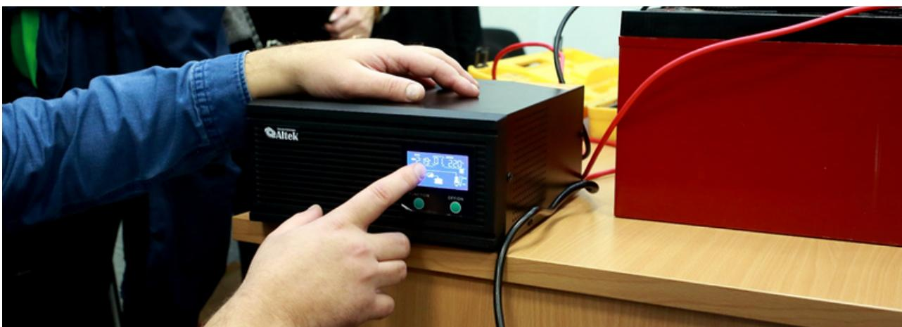
Наступним кроком потрібно приєднати контролер заряду до акумулятора, якщо він вже не вбудований в інвертор. Переріз проводу повинен бути вказаний в інструкції до контролера. До клем контролера провід під'єднується затисканням викруткою кінця проводу зі знятою ізоляцією. За наявності спеціального інструменту цей кінець обжимається гільзою для більш надійного контакту. Перед приєднанням обов'язково перевірте співпадіння полюсів.
